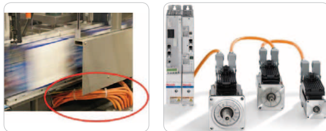
Obr. 2 Pred rekonštrukciou (hore) a po nej – predchádzajúci model stroja Veronica vyžadoval jeden kábel pre každý motor/pohon, pričom nové riešenie prepája motory a pohony jedným káblom
